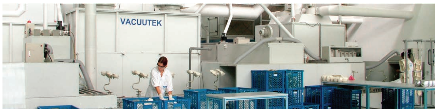
Aplicação e cura de verniz UV para Lentes de policarbonato e refletores de BMC com pré-tratamento com UV
